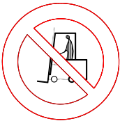
PROHIBIDO A LOS VEHICULOS DE MANUTENCION
